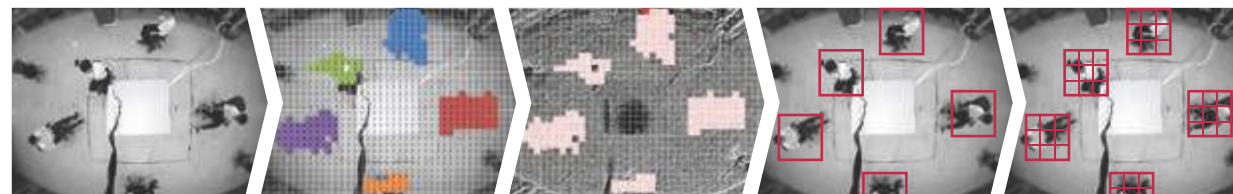
Wprowadzanie obrazu Wykrycie ruchu Wybór kandydatów Analiza Finalne wykrycie ludzkiego ciała
